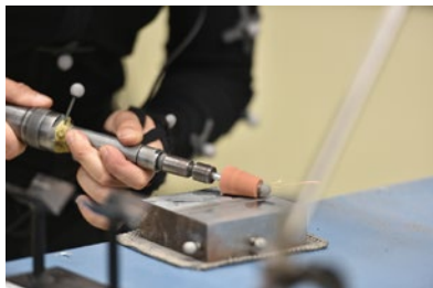
手元にある金属を、やすりを往復させて磨く。このときどこを見ているのかも、視線計測機が記録している。
