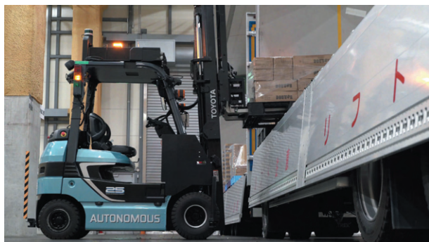
自動運転フォークリフトによる荷下ろし/荷積みの実証実験
