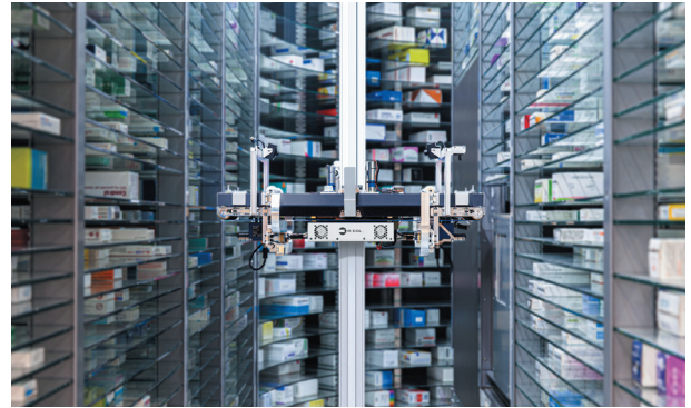
最新型の自動入庫払出装置
